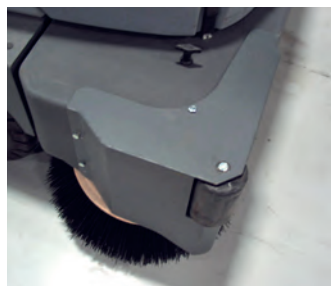
Hoekbeschermers zijborstel Beschermt zowel machine als zijborstel
